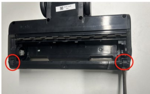
05. Fixer le clapet à l'aide d'un tournevis droit.
